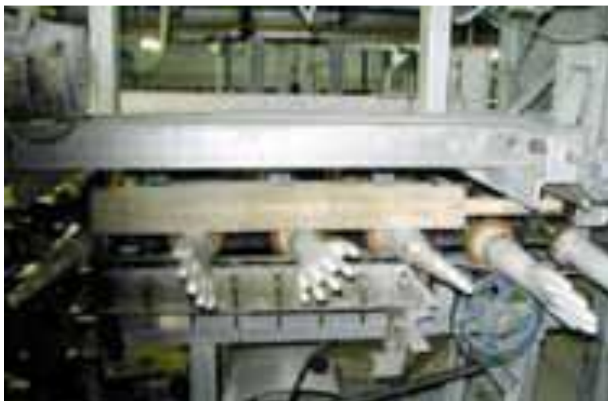
รูปที่ 12 การม้วนขอบถุงมือยางโดยใช้แปรง
