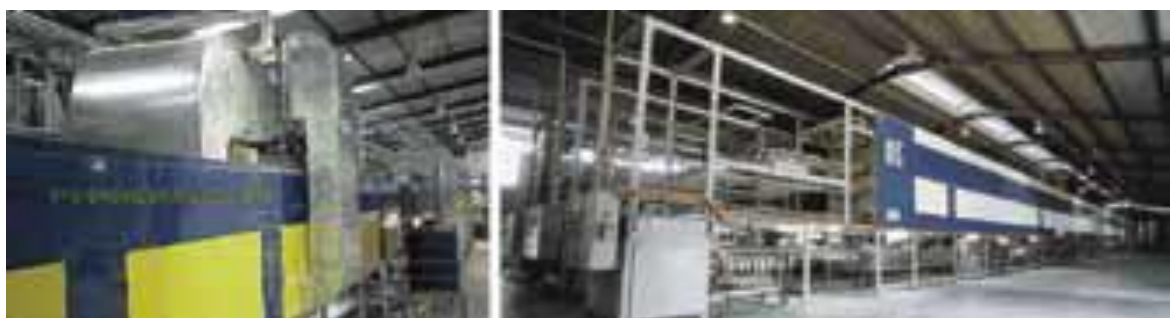
รูปที่ 14 แสดงตู้อบหลักของการอบถุงมือยางเพื่อให้ยางคงรูป
