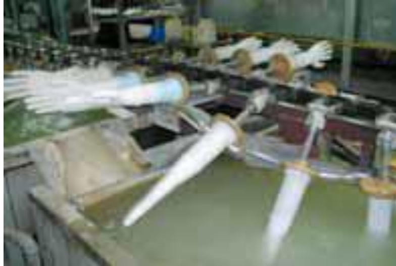
รูปที่ 13 แสดงการชะล้างฟิล์มถุงมือยางในถัง Leaching
